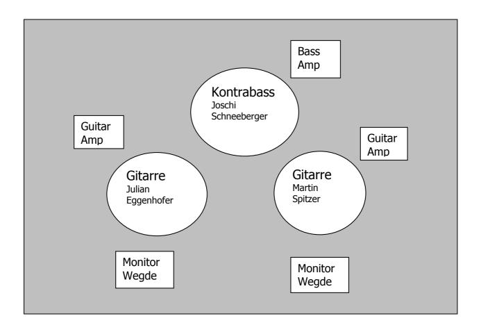
**Backline:** Wir bringen unsere Gitarren Amps und den Bass Amp mit. Alle Amps haben integrierte DI Boxen mit XLR Anschlüssen.
